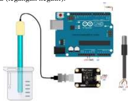
Gambar 3. Komunikasi Sensor pH Meter dan Waterproof dS18B20
