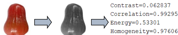
Gambar 4. Proses Ekstrasi Gambar Dengan GLCM di Matlab 2018a
