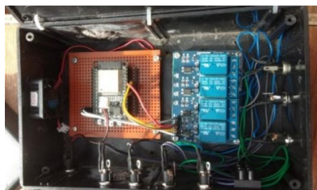
Gambar 9. Implementasi NodeMCU ESP32 dengan relay
