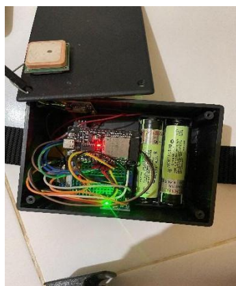
Gambar 3. Perangkat pengirim yang dipasang pada ternak sapi
