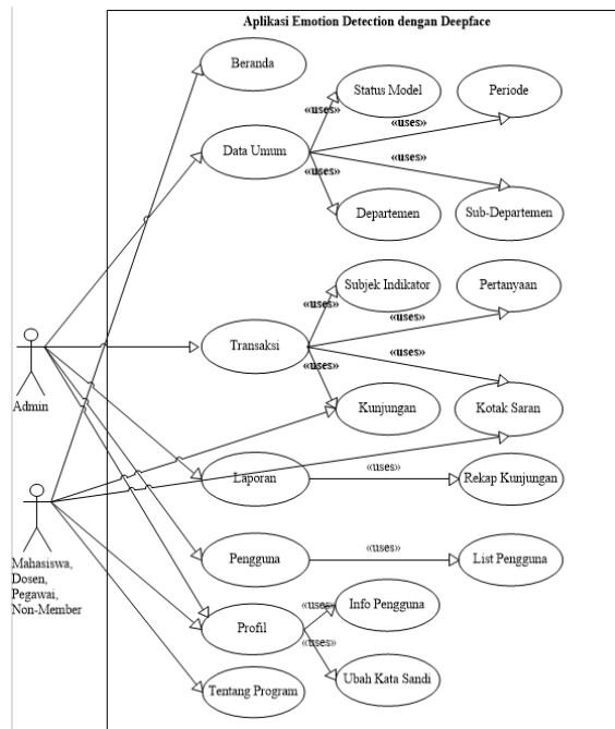
Gambar 2. Use Case Diagram Aplikasi Emotion Detection dengan metode Deepface
