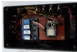
Gambar 13. Implementasi Sistem Kendali Relay di dalam Greenhouse
