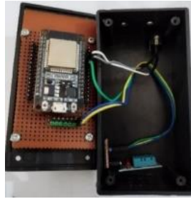
Gambar 9. Implementasi sistem pembacaan suhu dan kelembapan udara
