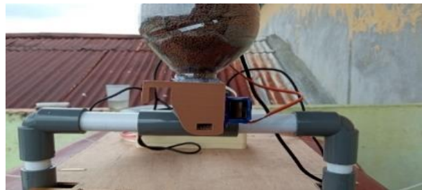
Gambar 7. Implementasi Tower Pro Micro Servo 9g SG90 pada Buka-tutup Celah Pakan
