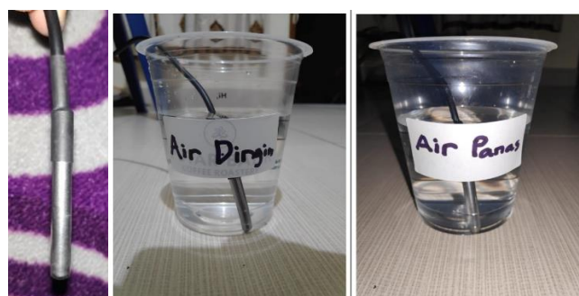
Gambar 8. Sensor DS18B20 dan pengujian menggunakan air panas dan air dingin
