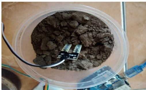
Gambar 5. Instalasi Perangkat Input Rain Sensor
