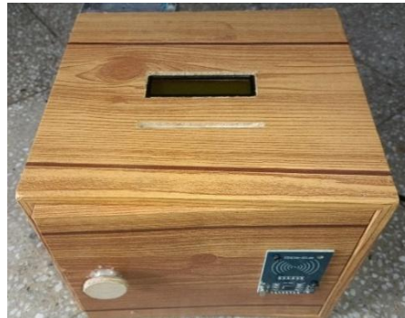
Gambar 7. Implementasi Fisik Perangkat Celengan Cerdas IoT
